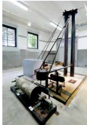
欧米から輸入した地震計、日本の地震に合わせて独自に開発した地震計など地震研究の歴史がわかる展示。写真は2代目所長が開発、世界に1台しかない佐々式大震計
